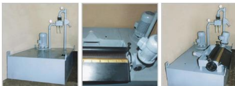
Instalatie pentru vehicularea si epurarea lichidelor de racire cu hidrocyclon
